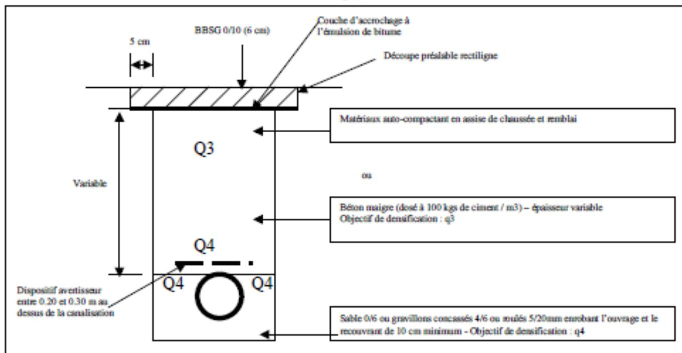
Avant la réalisation de la couche de roulement, une découpe sera réalisée à 10 cm de la première coupe pour croisement de cette dernière surface avec l'enrobé existant.
