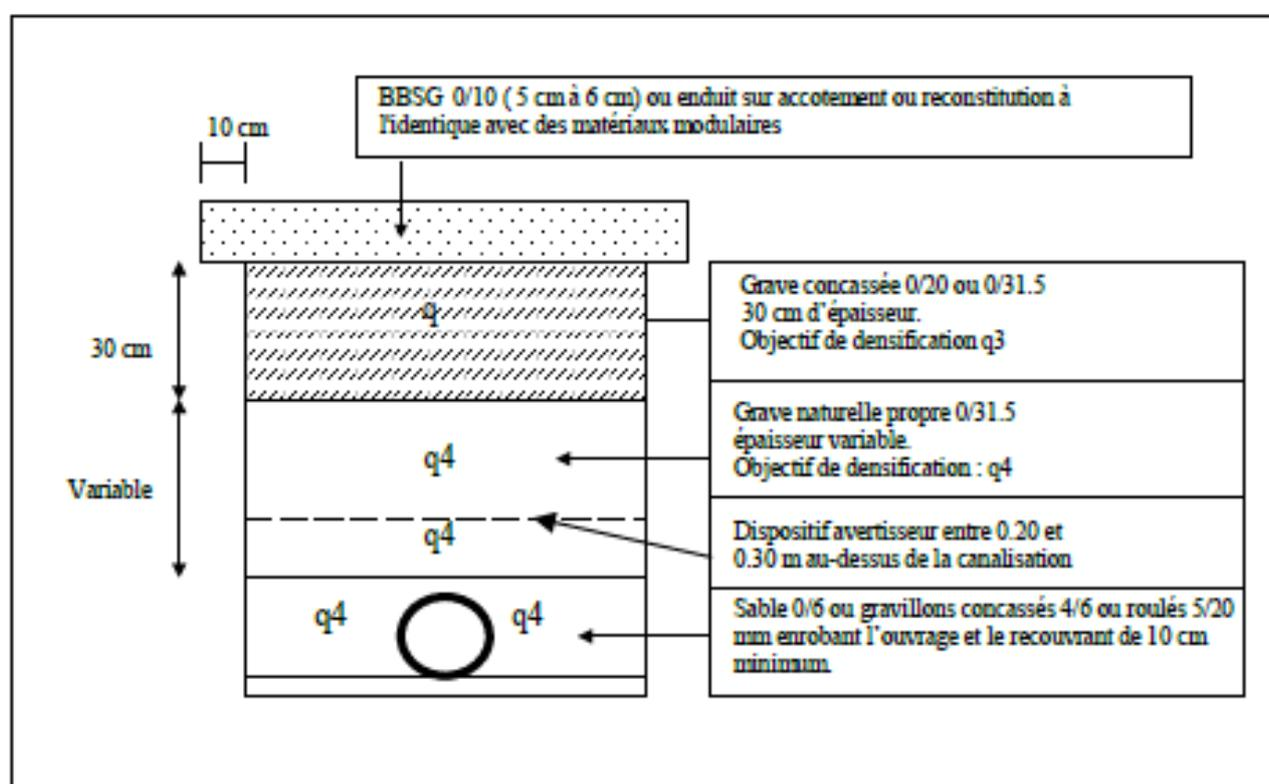
Si la tranchée ne peut être implantée à une distance au moins égale à sa profondeur (distance du bord de chaussée), la partie inférieure de remblai sera réalisée avec un compactage dont l'objectif de densification est q3 pour les 60 cm supérieurs de remblai.
