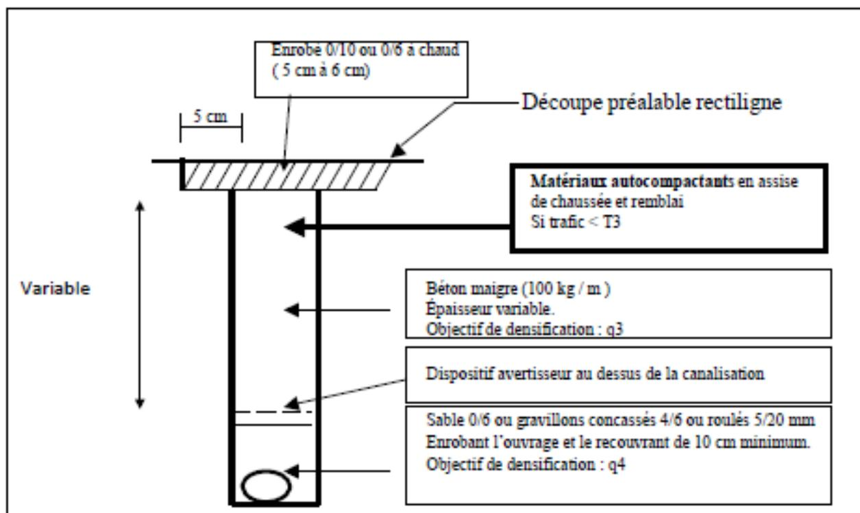
Avant la réalisation de la couche de roulement, une découpe sera réalisée à 5 cm de la première coupe pour croisement de cette dernière surface avec l'enrobé existant.
