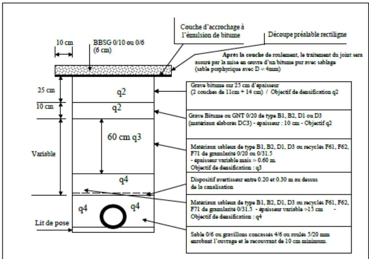
Avant la réalisation de la couche de roulement, une découpe sera réalisée à 10 cm de la première coupe pour croisement de cette dernière surface avec l'enrobé existant.
